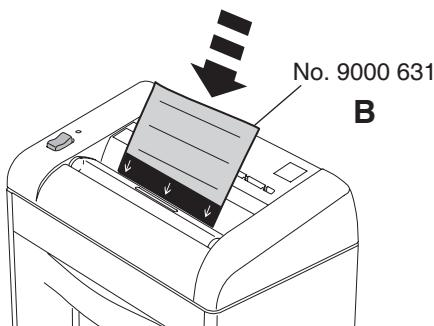
عند انخفاض مستوى أداء الآلة أو بعد امتلاء وعاء التجميع المرجو دهن آداة القص بالزيت (انظر الصورة).
